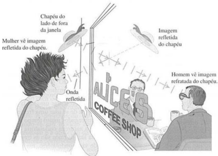
Figura 27 – Reflexão e refração.
