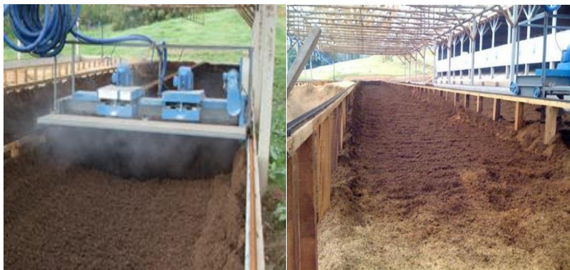
Figura 2. 1: Sistema mecanizado para compostagem de dejetos suínos no Brasil.
