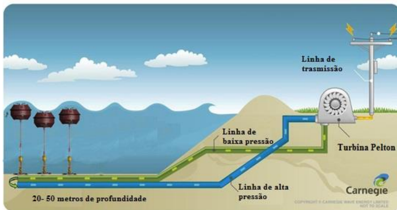
Figura 8.7: Princípio de funcionamento. Fonte: CETO ENERGY, 2015.
