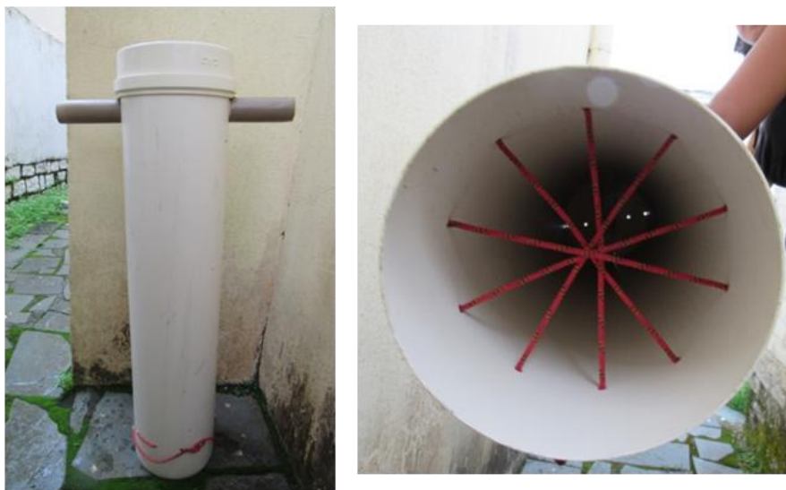
Figura 9 - Corer utilizado para coleta do substrato, demonstrando a delimitação interna de 10cm.
