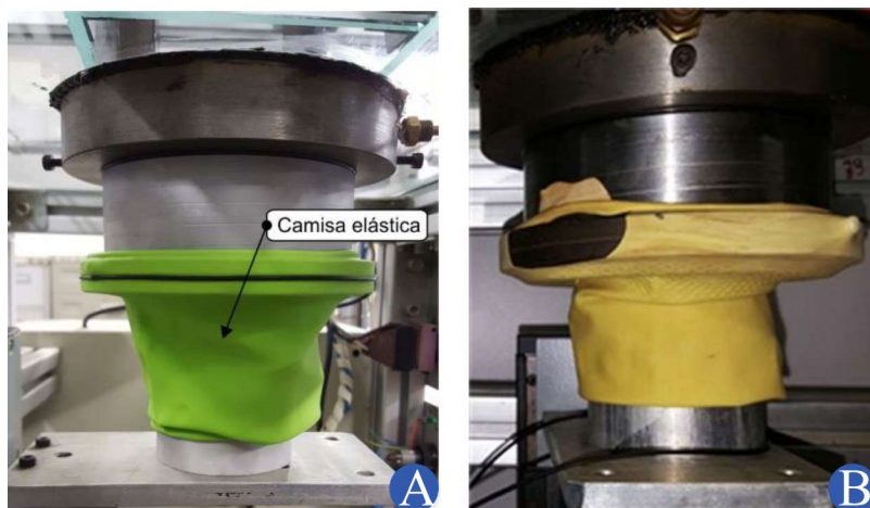
Figura 36 – (A) Camisa elástica montada na base do pistão e na parte externa inferior do cilindro de trabalho (B) camisa elástica danificada.
