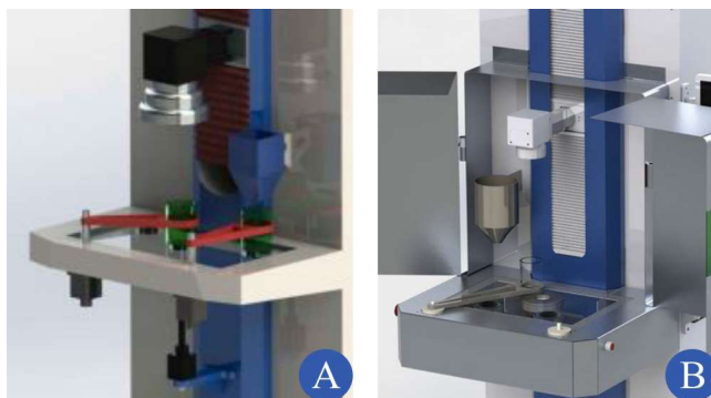
Figura 55 – Dispositivo de deposição de pó metálico com movimentação angular, com dois reservatórios (A) e com um reservatório (B).
