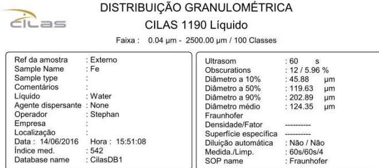
Figura A1- Resultado de granulometria dos pós de ferro não peneirado
