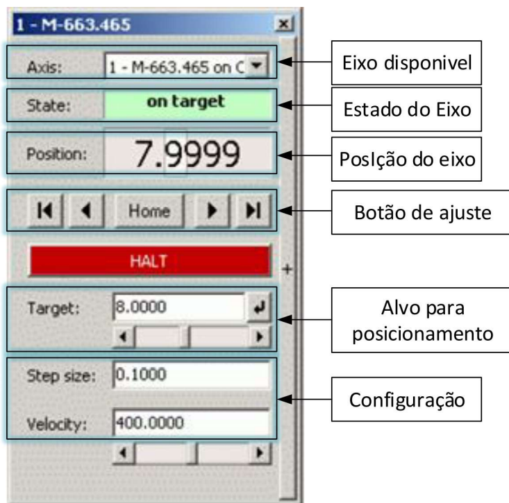
Figura 46 - Painel de controle da mesa de elevação (eixo vertical). [49] Figura 1
