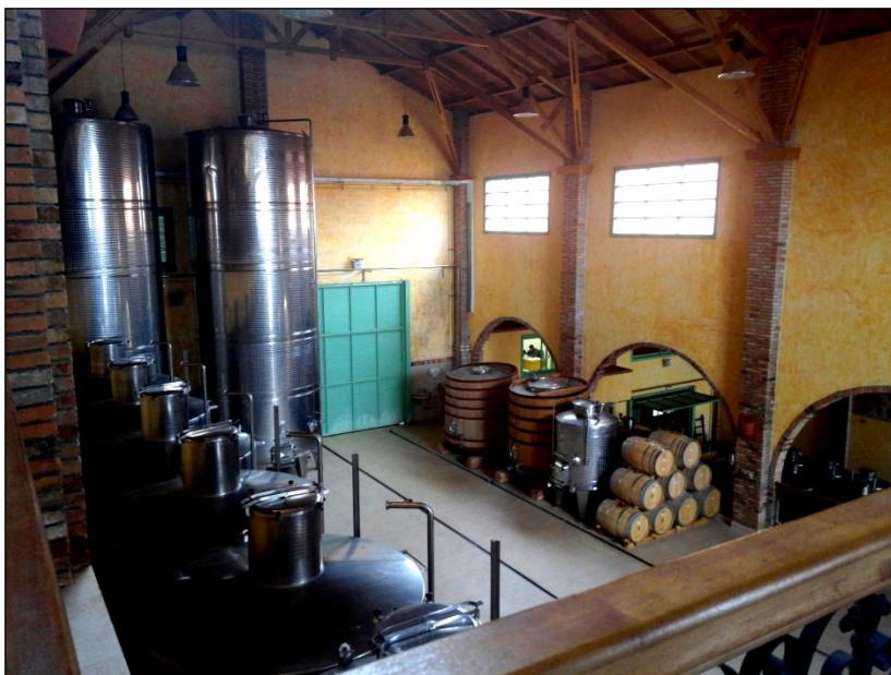
Figura 6: Piso com equipamentos para o processo de fermentação, Villa Francioni.
