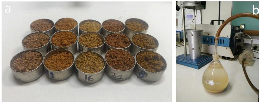
Figura 36. (a) Cápsulas para análise de teor de umidade; (b) Picnômetro utilizado no ensaio de massa específica dos sólidos.
