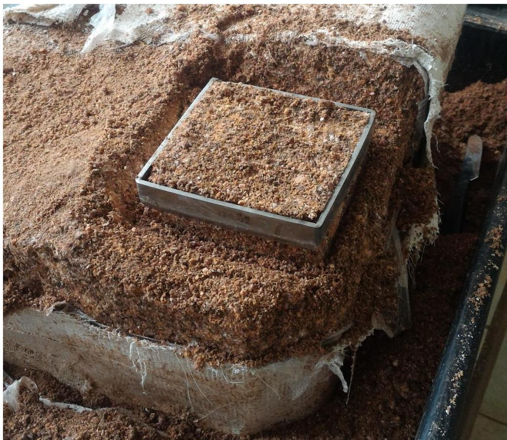
Figura 40. Amostragem em bloco indeformado.
