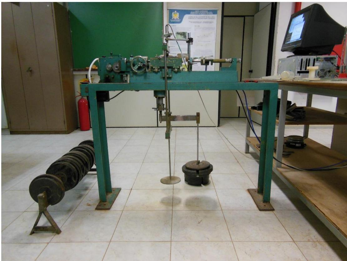
Figura 39. Equipamento de cisalhamento direto do Laboratório de Mecânica dos Solos.
