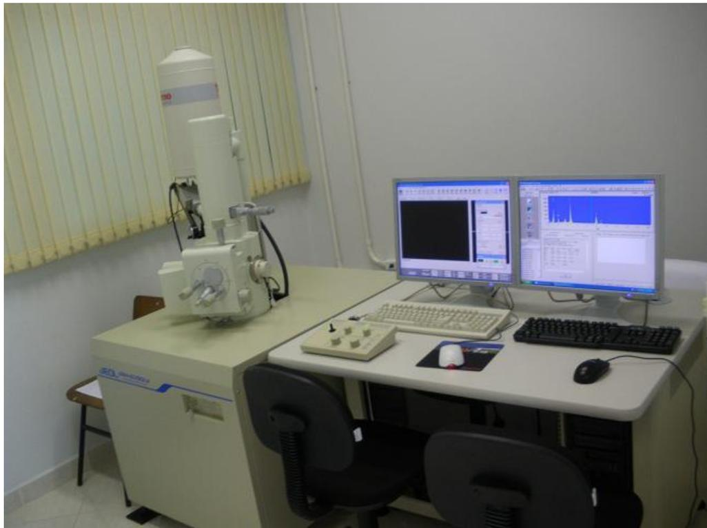
Figura 41. Microscópio eletrônico de varredura modelo JSM 6390LV (LCME-UFSC).
