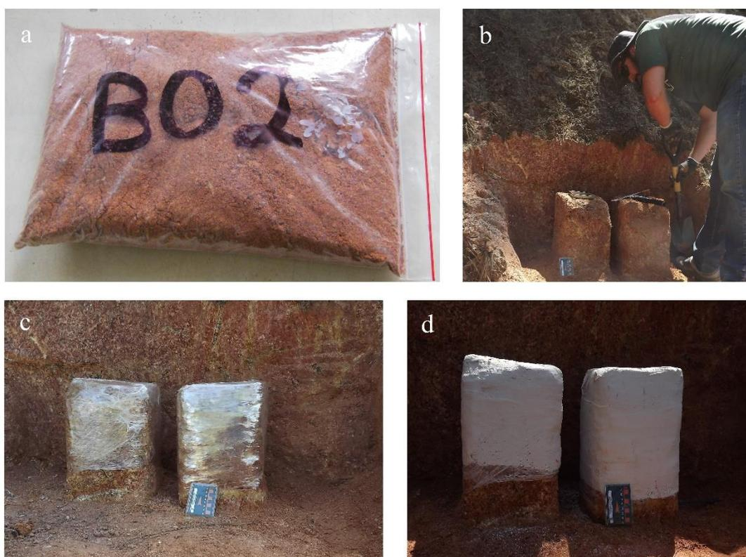
Figura 35. (a) amostra deformada; (b) uso de ferramentas manuais para moldagem; (c) filme plástico usado para manter a umidade da amostra; (d) atadura gessada usada para transportar a amostra com segurança.
