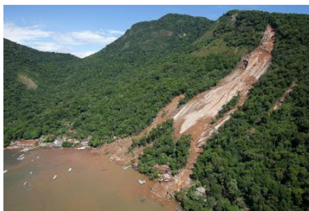
Figura 5. Deslizamento translacional ocorrido na Praia do Bananal, Ilha Grande, 2010. Fonte: aquafluxus.com.br
