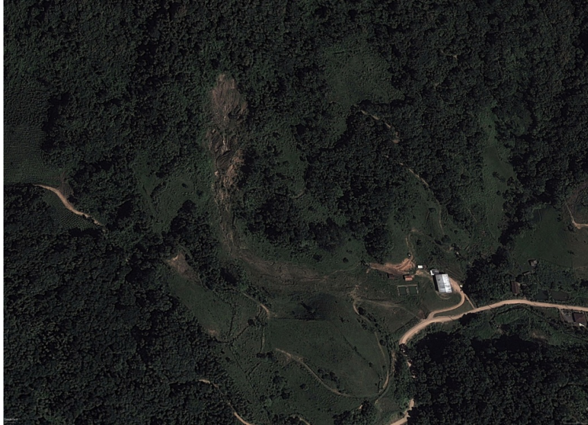
Figura 33. Imagem do Google Earth que mostra a extensão do deslizamento no bairro Ipiranga. Fonte: Google Earth, 2016.
