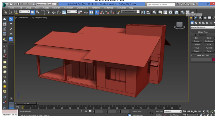
Figura 7 – Exemplo de modelagem 3D em projeto com formas retilíneas, elaborado em software 3D Studio Max, baseado em geometria plana e descritiva.
