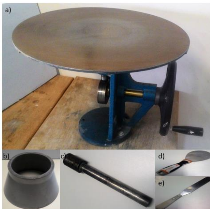
Figura 15: a) mesa para realização do FTT; b) molde tronco cônico; c) soquete; d) espátula para preenchimento do molde; e) espátula para rasar molde.
