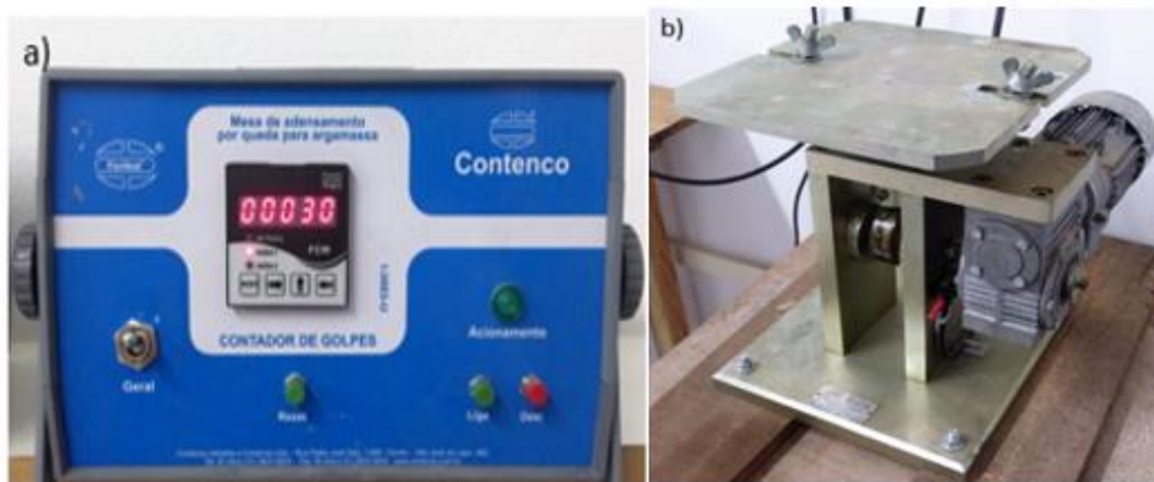
Figura 14: a) Contador de Golpes Automático; b) Mesa de adensamento por queda para argamassas
