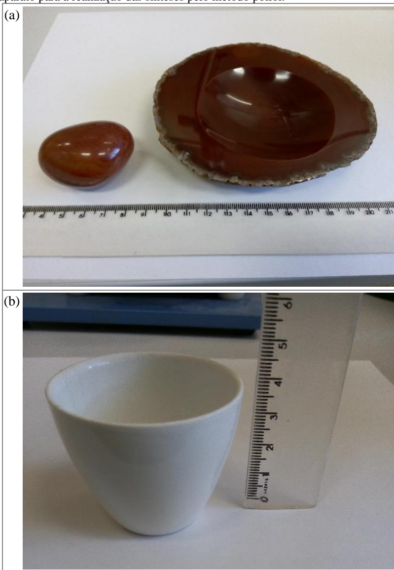
Figura 19. (a) Graal de ágata; (b) cadinhos de porcelana; (c) representação do balão de três bocas acoplado a um condensador sobre a placa de aquecimento – aparato para a realização das sínteses pelo método poliol.
