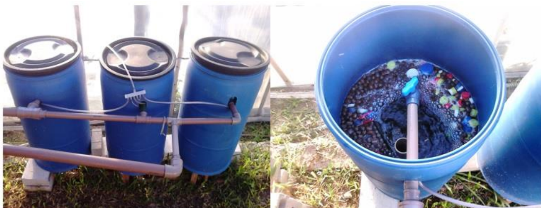
Figura 16 – Filtros biológicos com detalhe para os substratos
