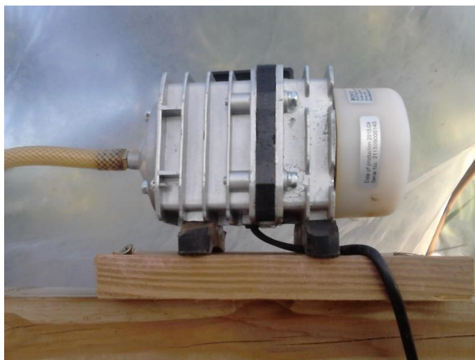
Figura 17 – Compressor de ar
