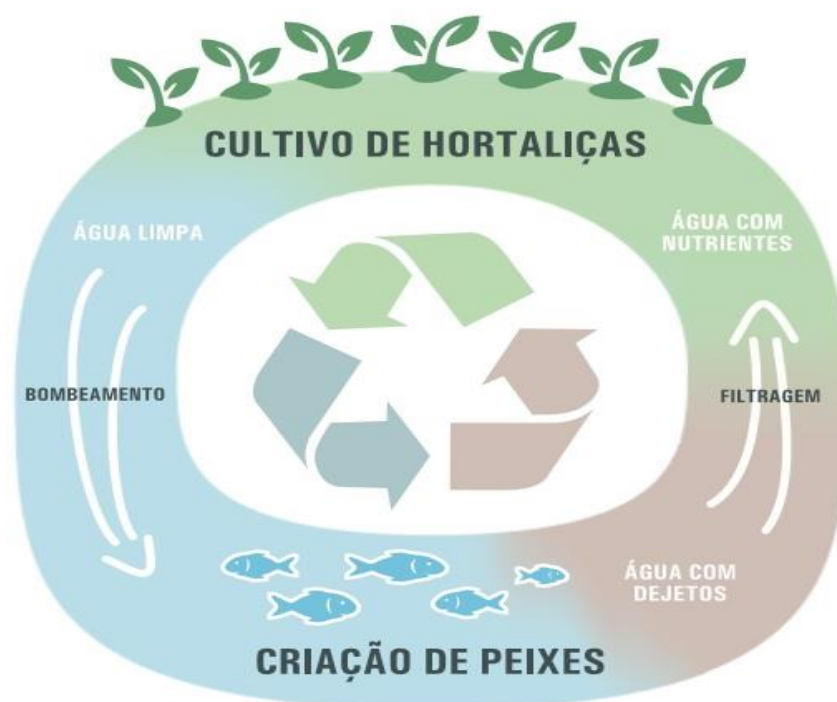
Figura 2 - Ciclo no sistema de Aquaponia
