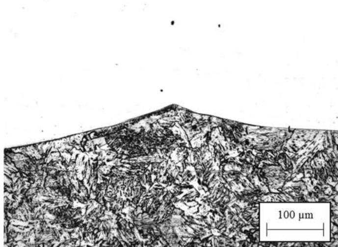
Figura 106 – Micrografia da interface MS/ZAC em cordão de soldagem realizada com gás Ar-H5
