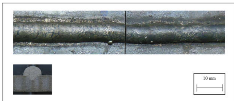
Figura 74 – Aspecto superficial e corte transversal do cordão realizado no modo CA adaptativo com gás Ar-H5.
