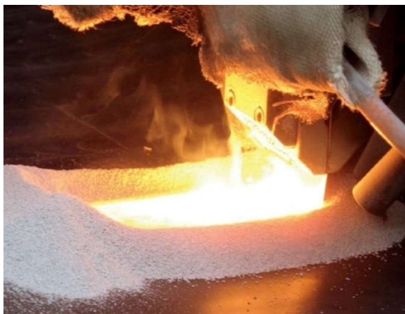
Figura 17 – “Cladding” com arco submerso utilizando fita.
