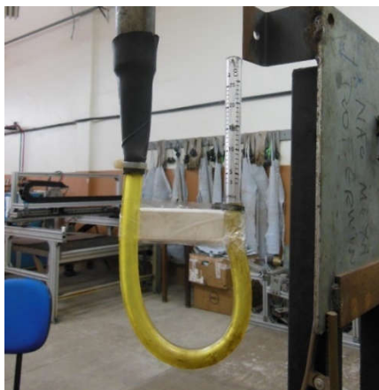
Figura 20 – Montagem utilizada para a medição da vazão de gás.
