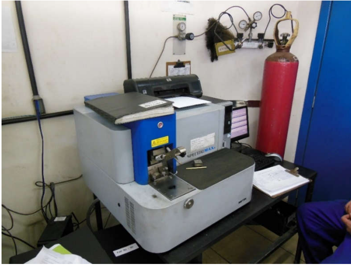
Figura 34 – Espectrômetro de emissão ótica Spectromaxx LMX06.
