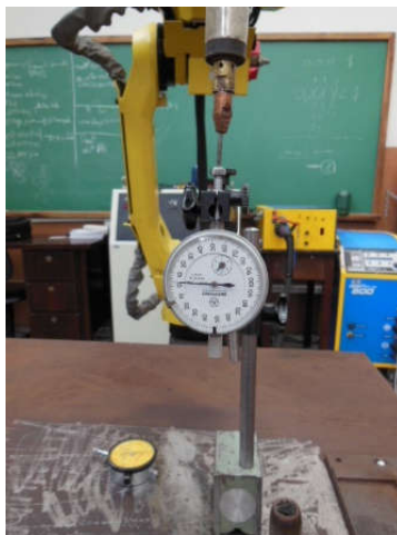
Figura 39 – Montagem para medição de repetibilidade
