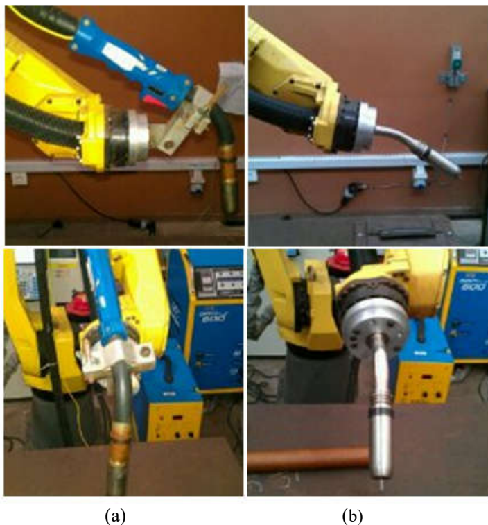
Figura 36 – Comparação entre as Tochas e Flanges: a) antiga e b) nova
