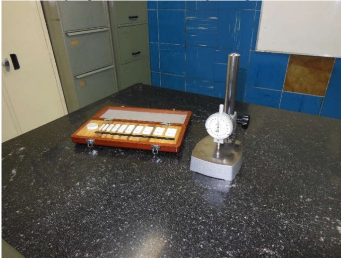
Figura 40 – Montagem para calibração do relógio comparador.
