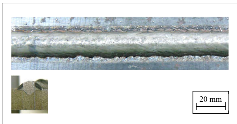
Figura 67 – Aspecto superficial e macrografia de soldagem com corrente pulsada e gás de proteção H 2
