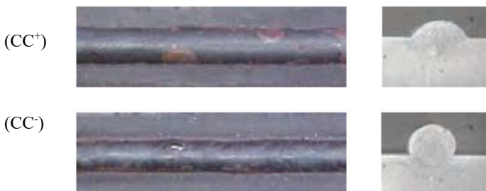
Figura 11 – Aspecto dos cordões e perfil de penetração de cordões de soldagem realizados com CC^+ e CC^- .
