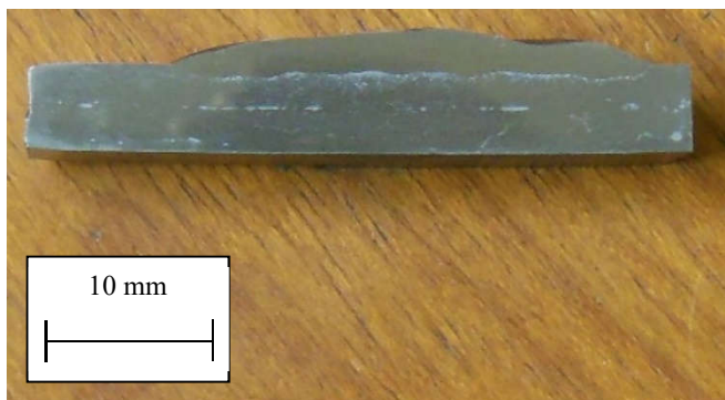
Figura 56 – Cordão de solda realizado com o processo arco submerso na posição plana com Inconel 625 com tecimento e polaridade negativa (ensaio 3a).
