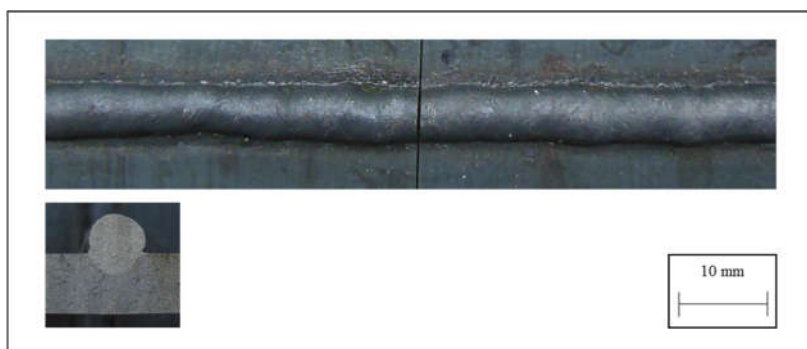
Figura 75 – Aspecto superficial e corte transversal do cordão realizado no modo CA adaptativo com gás Ar-O2.
