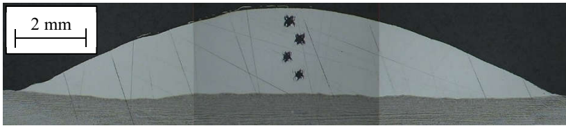
Figura 16 – Seção transversal de um cordão depositado na posição plana diluição de 5,38% e altura máxima de 2,41 mm.
