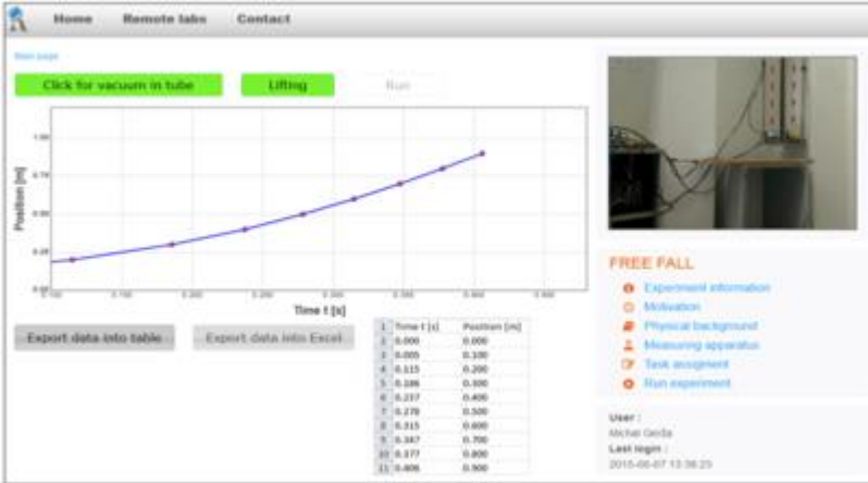
Figura 8: Experimento de queda livre em tubo com vácuo
