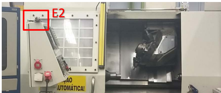
Figura 31 – Leitor 3 (E2) fixado sobre a caixa de comando do torno CNC.
