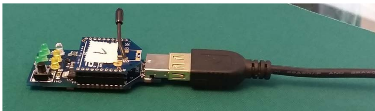
Figura 23 - Zigbee coordenador conectado ao cabo USB.
