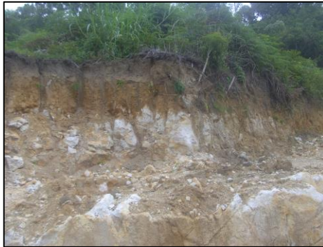
Figura 50: Horizonte de Cambissolo sobre área de desmonte de rocha. Bairro Prado, local de construção do posto de saúde.
