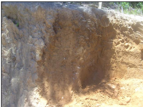
Figura 01: Perfil de Argissolo vermelho-amarelo em que foram retiradas as amostras deformadas e amostra indeformada. Bairro Prado.
