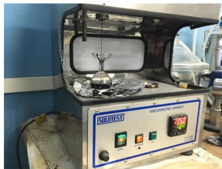
Figura 3.5 - Viscosímetro Saybolt-Furol e ensaio de viscosidade.
