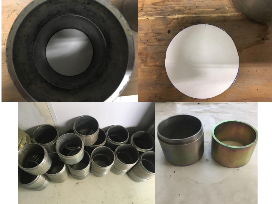
Figura 4.2 - Moldes e anel utilizados para moldar os corpos de prova.
