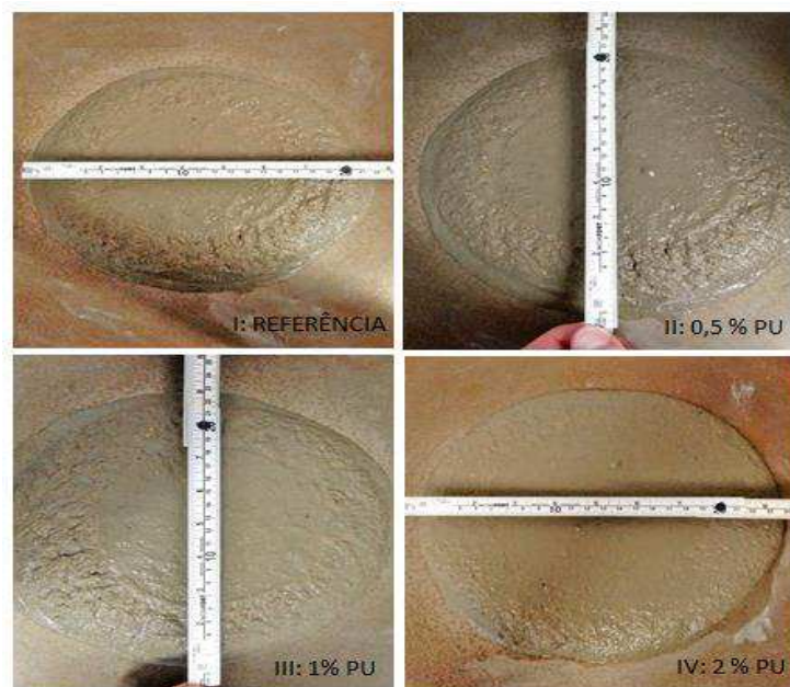
Figura 24: Abertura da argamassa na mesa de consistência.
