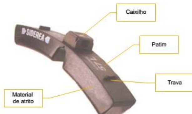
Figura 28 – Esquema sapata de composição não metálica
