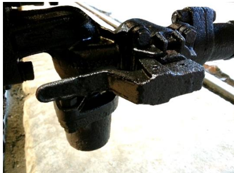
Figura 20 – Coletor de Pó com Torneira Combinada
