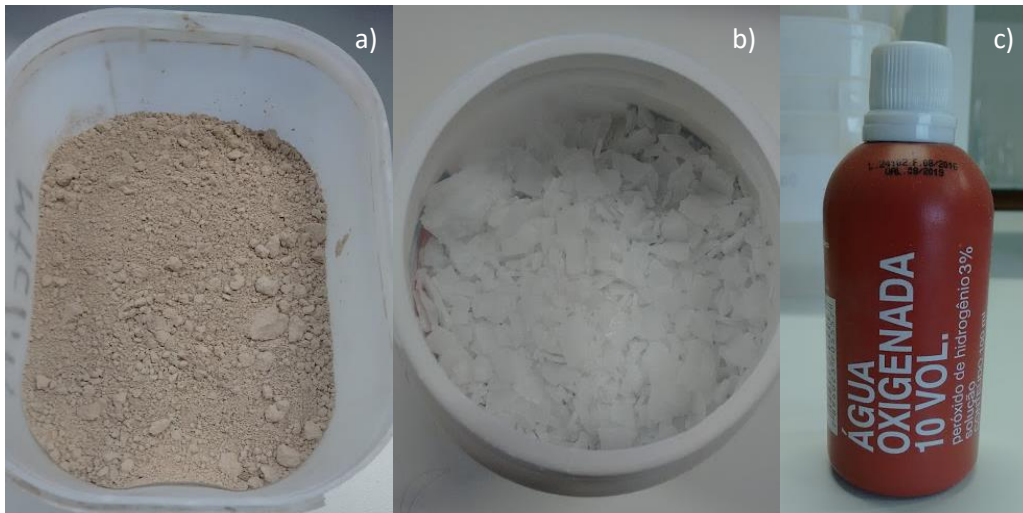
Figura 7 - Materiais utilizados para realização do geopolímero poroso. a) Metacaulim; b) Hidróxido de Sódio e c) Água Oxigenada.
