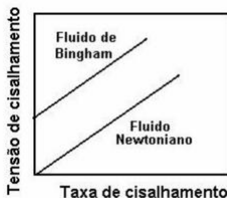
Figura 4 - Comportamento de um fluido newtoniano e comportamento de um fluido de Bingham.
