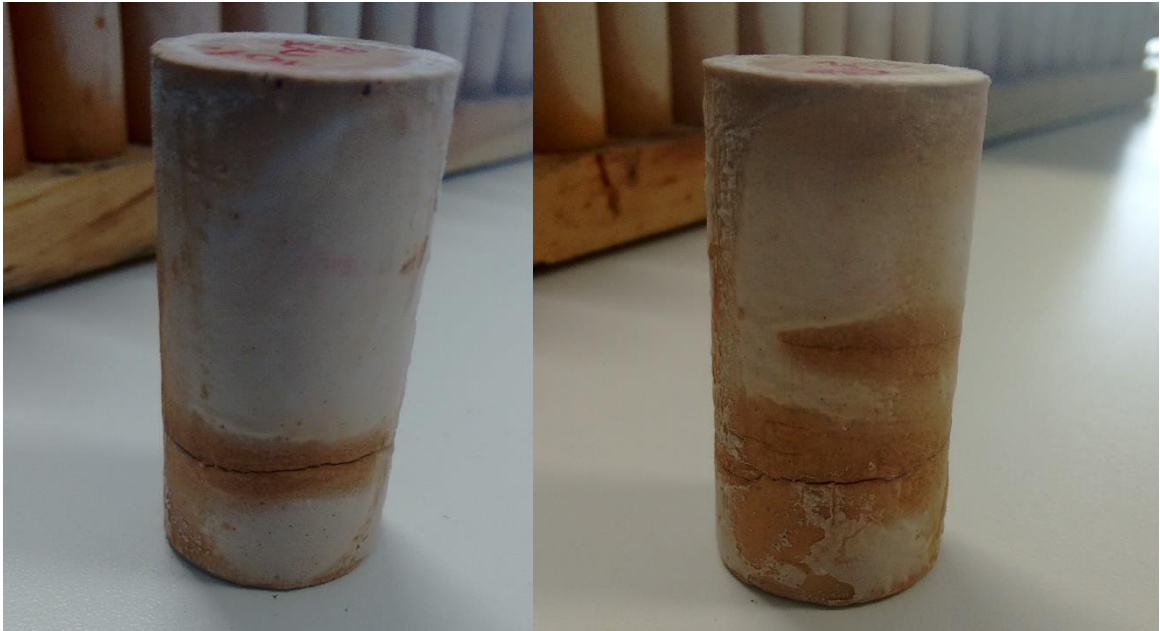
Figura 20 - Fissuras nos CPs com H 2 O curadas 28 dias.
