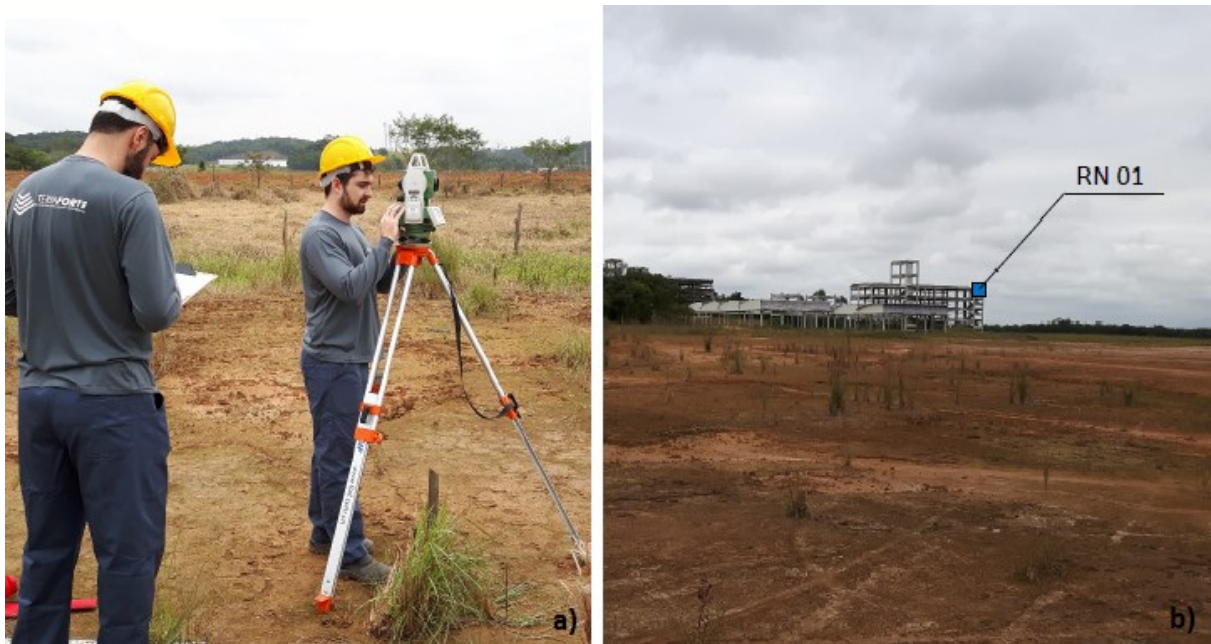
Figura 16 - a) Instalação da estação total; b) Vista do SP-01 para o RN 01
