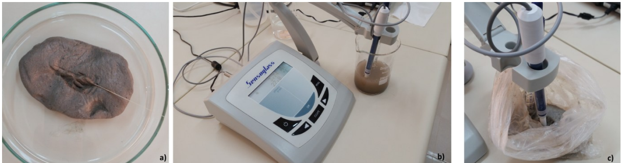
Figura 27 - Medições a) papel indicador; b) solução com Phmetro; c) direta com Phmetro
