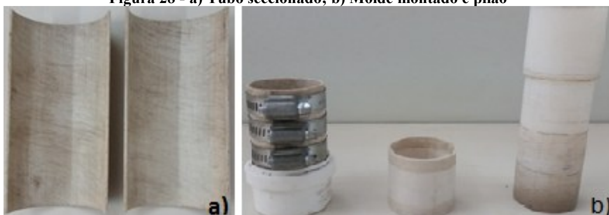
Figura 28 - a) Tubo seccionado; b) Molde montado e pilão
