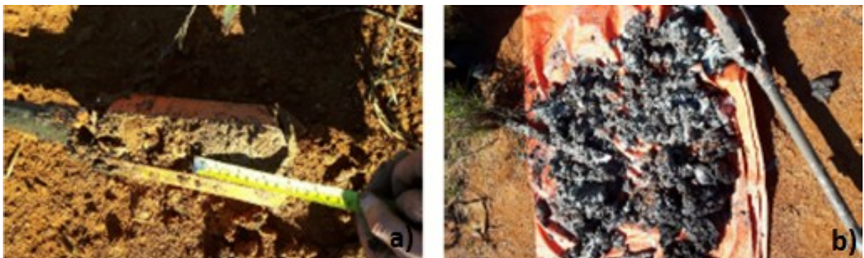
Figura 17 - a) Transição de camadas; b) Solo retirado da sondagem SP-01
