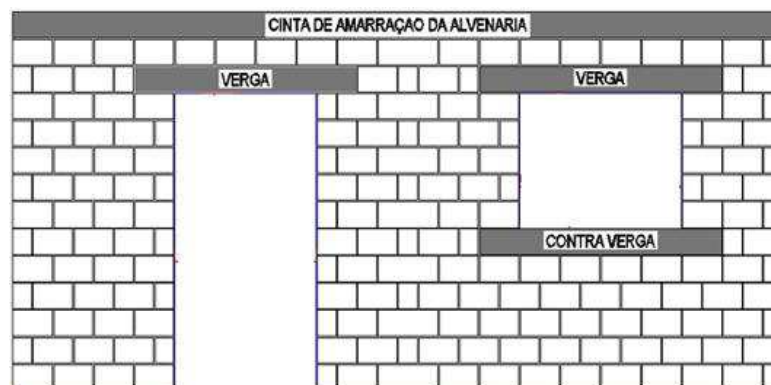
Figura 7: Cinta de amarração e verga e contra verga em uma estrutura.
