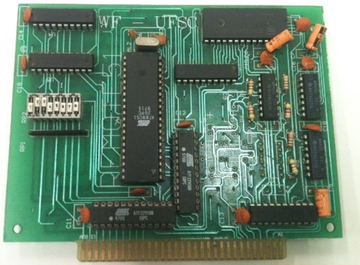
Figura 31 - Placa RExLab contendo o microcontrolador 8051
