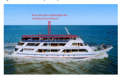
Figura 30 – Área útil disponível para alocar os módulos fotovoltaicos
