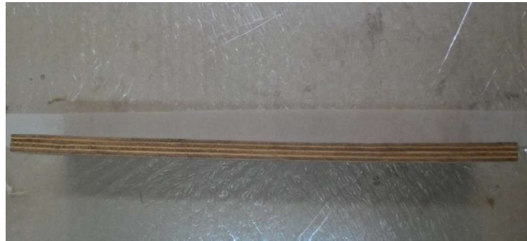
Figura 18 – Empenamento dos CDPF com baixo teor de umidade
