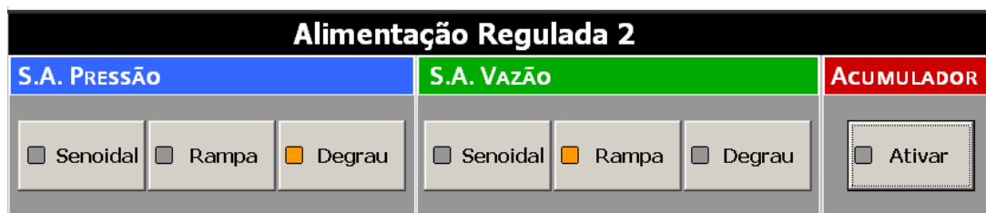
Figura 34 – Detalhe dos três menus para definição dos parâmetros de uso da linha 2: menu para regulação de pressão (E), menu para regulação de vazão (C) e menu para utilização do Acumulador (D).
