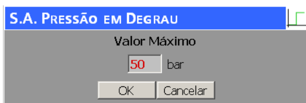
Figura 30 – Submenu para configuração da saída do tipo degrau de pressão, nesse caso. O submenu Degrau para vazão é semelhante.
