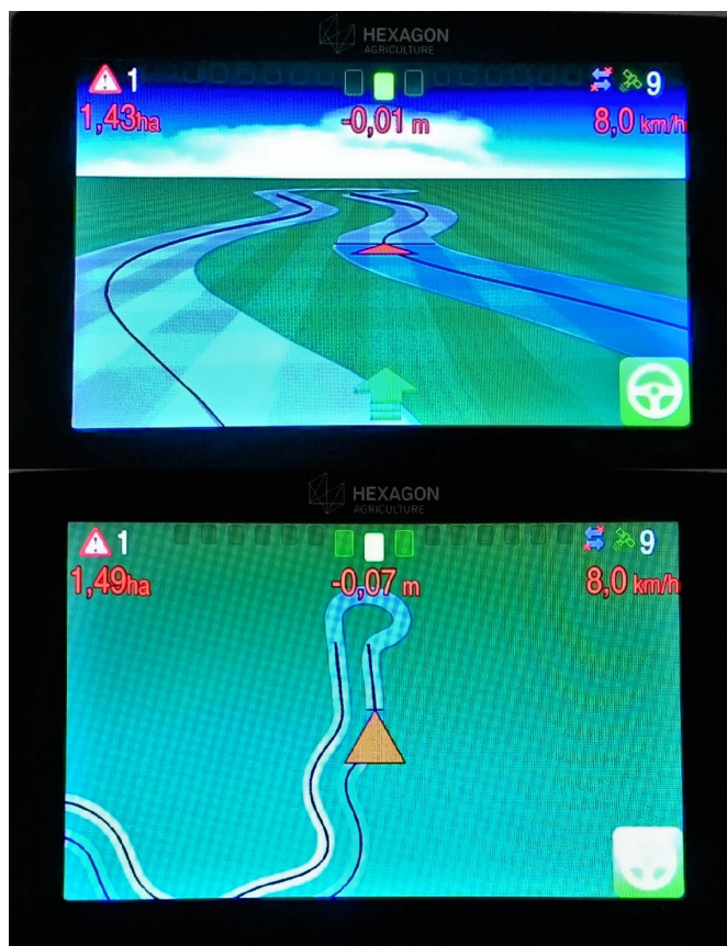
FIGURA 5.10: Trajetórias de referência em curva e trajetória do veículo a partir de uma visão 3D, acima, e 2D, abaixo. (Fonte: Autor)
