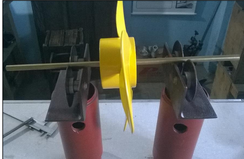
Figura 44 - Dispositivo para balanceamento do hélice
