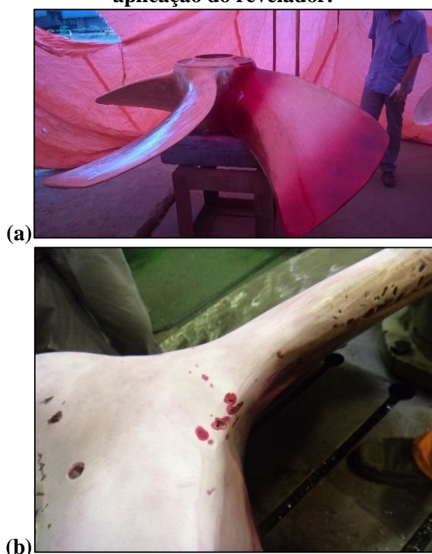
Figura 13 - Ensaio de líquido penetrante. (a) Aplicação de LP e (b) resultado da aplicação do revelador.
