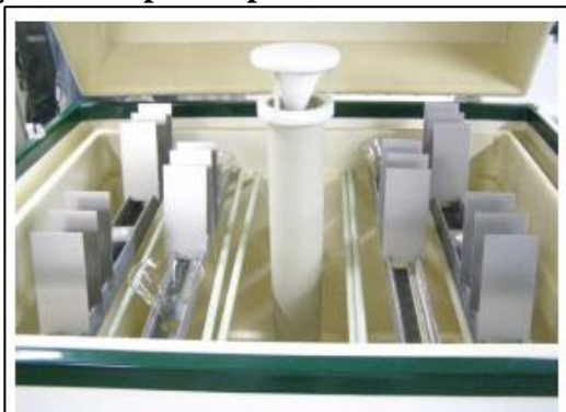
Figura 14 - Disposição de corpos de prova na câmara de névoa salina.
