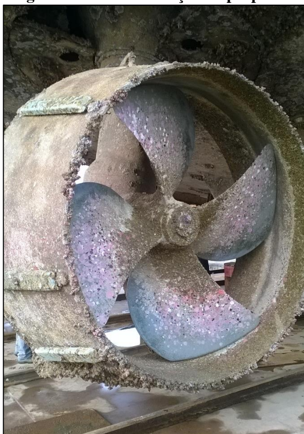
Figura 12 - Bioincrustação no propulsor.
