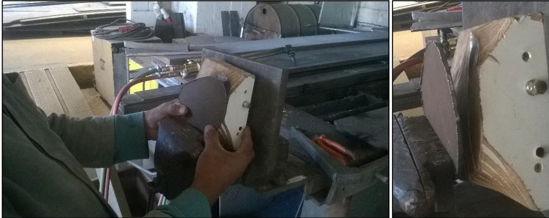
Figura 36 - Posicionamento e fixação da pá no gabarito.
