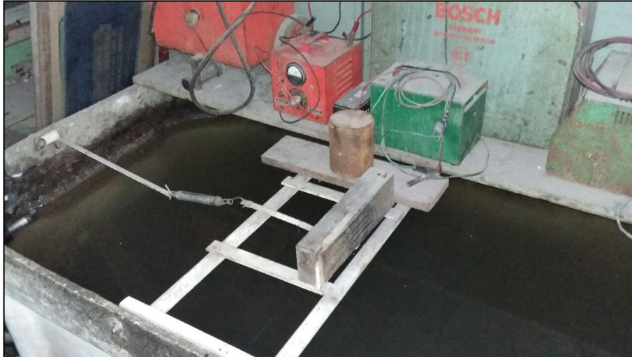
Figura 43 - Mecanismo de ensaio de força de empuxo.
