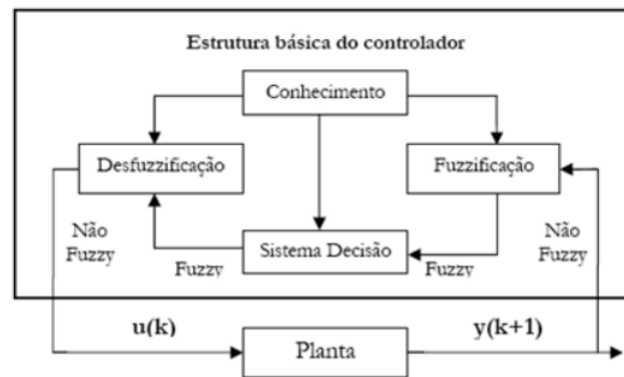
Figura 43 – Diagrama de blocos da estrutura básica de um controlador fuzzy
