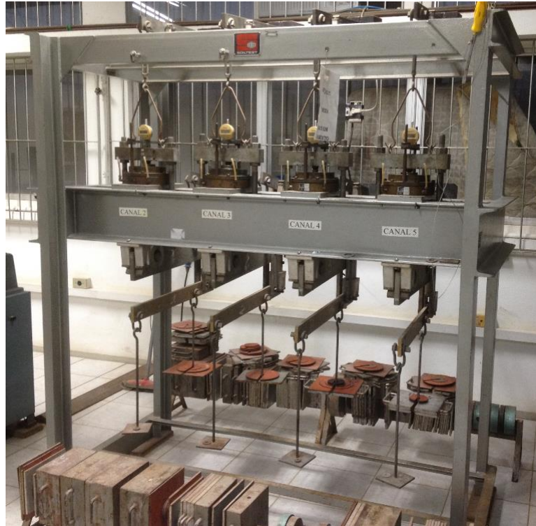
Figura 22. Equipamento de compressão unidimensional utilizado na quantificação do colapso.
