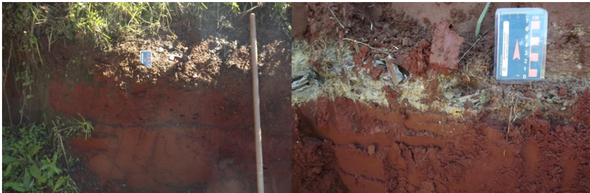
Figura 30. Ponto 84 e camada de pelito intemperizado que cobre o solo de areia quartzosa podzolizada.
