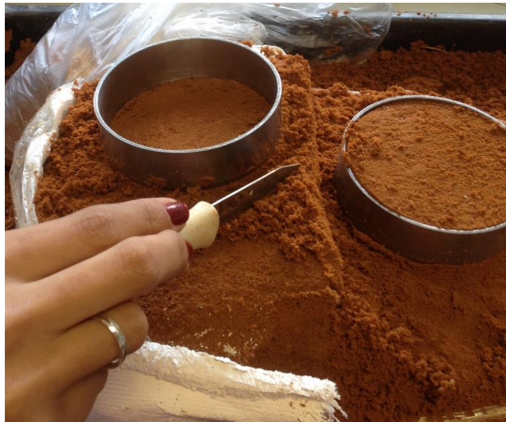
Figura 23. Moldagem do corpo de prova do ensaio de compressão unidimensional.
