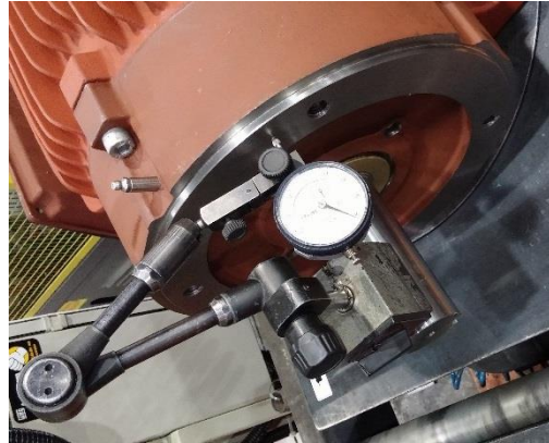
Figura 10 - Medição de batimento axial em um motor com relógio comparador e base magnética
