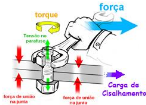
Figura 20 – Forças aplicadas a um parafuso
