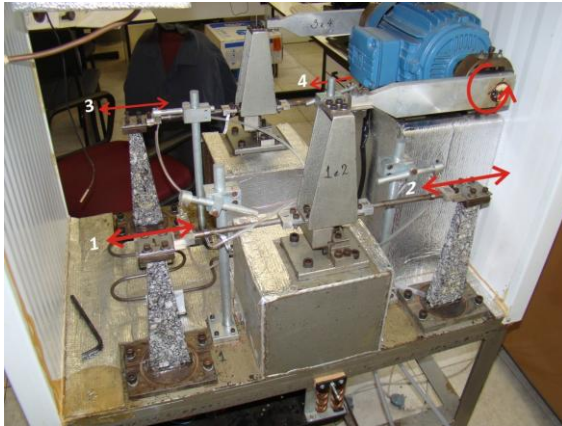
Figura 2.24 – Primeiro protótipo de Máquina de Módulo Complexo e Fadiga da Universidade Federal de Santa Catarina.
