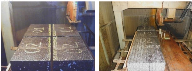
Figura 4.5 – Exemplo de serragem das placas para obtenção dos corpos de prova.
