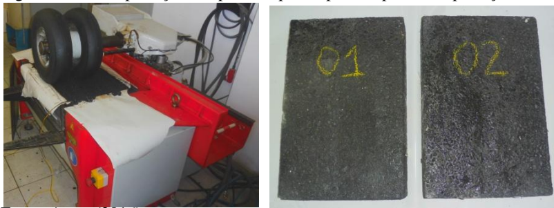
Figura 4.4 – Compactação das placas e par de placas após a compactação.
