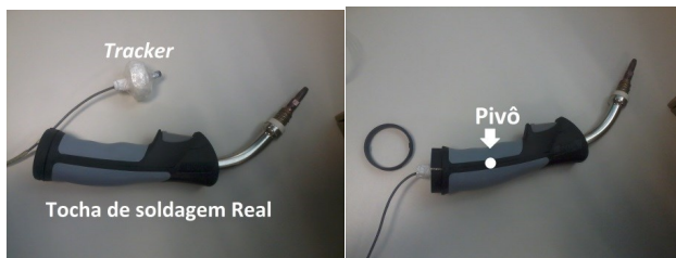
Figura 8 – Tracker Incorporado a Pistola de Solda
