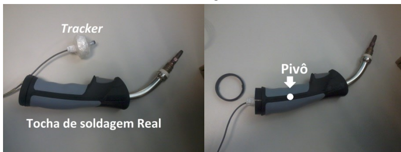
Figura 20 – Imagem do Tracker Incorporado a Pistola de Soldagem
