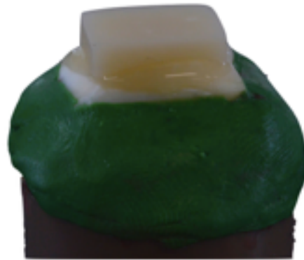
Figura 13 - Bloco de resina assentado sobre cimento autoadesivo
