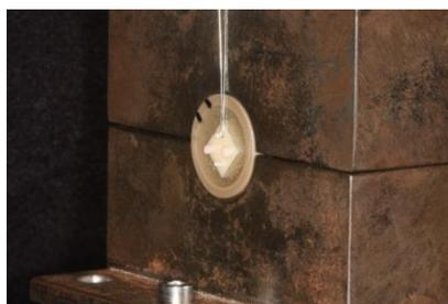
**Figura 16:** Corpo de prova sendo tracionado por fio de aço 0,025mm em Máquina Universal de Ensaio.
