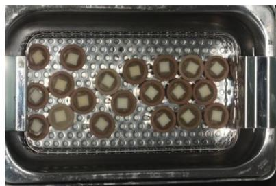
**Figura 7:** Blocos submetidos ao banho ultrassônico.
