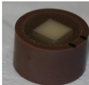
**Figura 5:** Bloco de RAAQ (Alike, GC AmericaInc), incluído em cilindro de PVC preenchido com RAAQ incolor (Resina Auto TDV, TDV Dental Ltda.).
