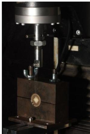
**Figura 15:** Máquina Universal de Ensaio (Instron 4444) com fio de aço 0,025mm para tração do corpo de prova.
