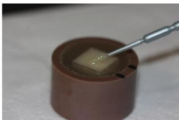
**Figura 10:** Aplicação do Primer Adesivo para Compósito de forma ativa com microbrush.
