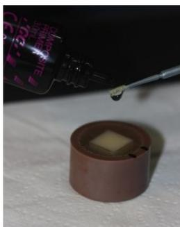
**Figura 9:** Aplicação do Primer Adesivo para Compósito (CompositePrimer, GC Europe).
