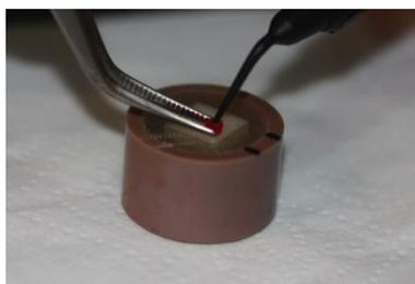
**Figura 12:** Inserção da RC (Gaenial Universal Flow, GC AmericaInc.) no cilindro.
