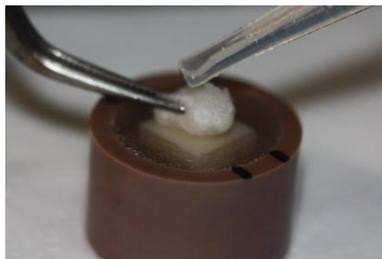
**Figura 8:** Condicionamento da superfície com monômero de metilmetacrilato (MMA) (Alike, GC AmericaInc.) por 180 segundos
