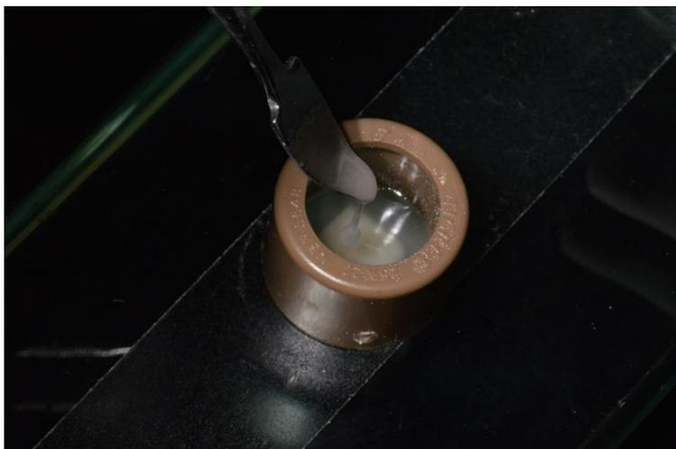
*Figura 2. Inserção da resina acrílica no cilindro de pvc.*
