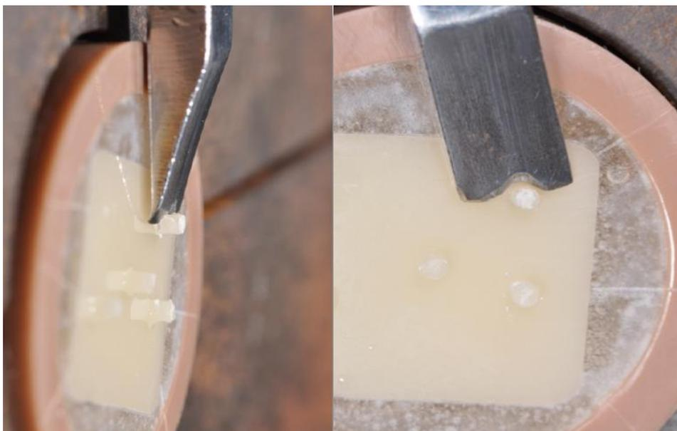
*Figura 8. Execução do teste de microcisalhamento.*
