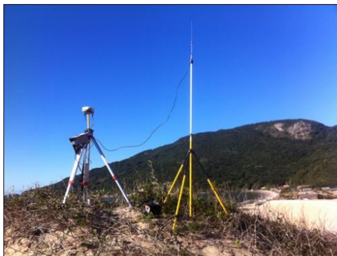
Figura 25: Base do DGPS (à esquerda) juntamente com a antena externa (à direita), posicionada no marco mais ao Norte do Sistema Santinho/Ingleses.
