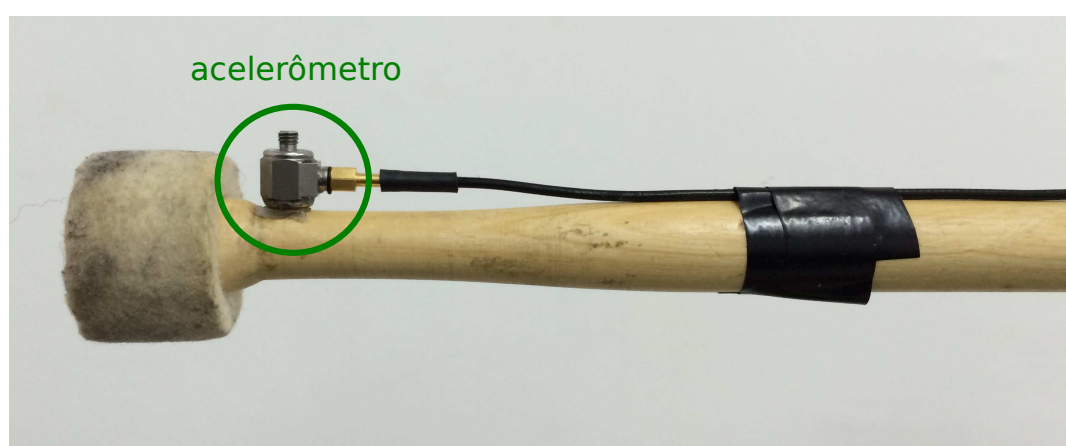
Figura B.7 – Mallet utilizado no experimento, com acelerômetro acoplado. Composto por uma haste de madeira, com um cilindro de feltro na ponta. Fonte: Autor
