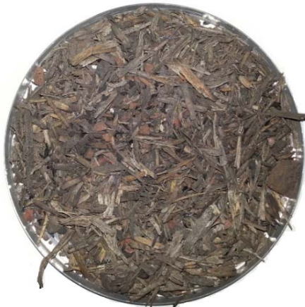
Figura 3.7 – Restos de bagaço de cana-de-açúcar retidos na peneira de 2,0mm proveniente do peneiramento da ACBC in natura
