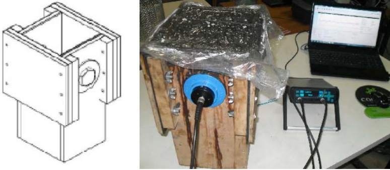
Figura 3.8 – Dispositivo para monitoramento de velocidades de pulsos ultrassônicos baseado no dispositivo de Irrigaray (2012)
