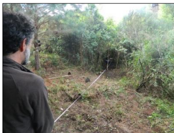
Figura 63 - Topografia realizada com nível ótico e régua de medição.
