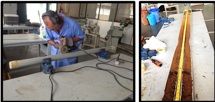
Figura 37 – Procedimento de abertura dos tubos de alumínio empregados nas sondagens à percussão manual.
