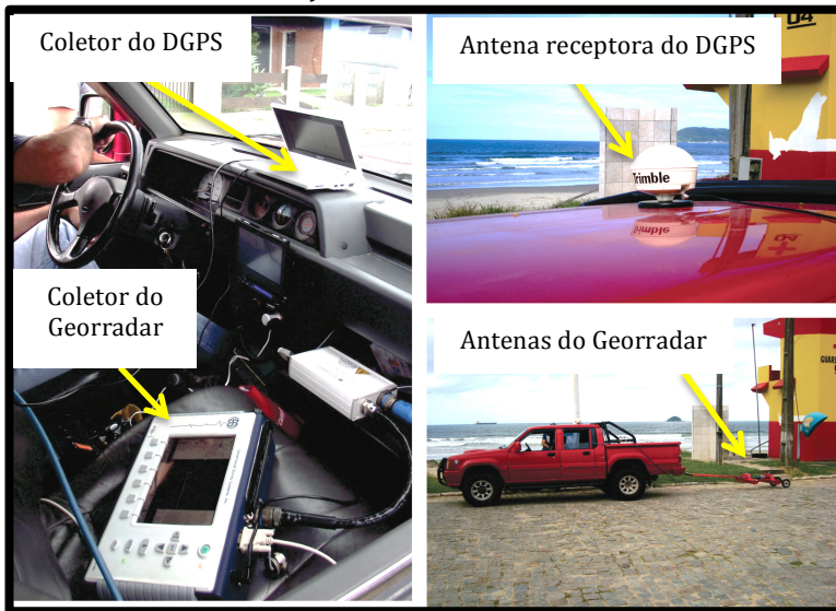
Figura 40 – Esquema de funcionamento dos equipamentos utilizados para a obtenção das coordenadas geográficas das seções de Georradar.
