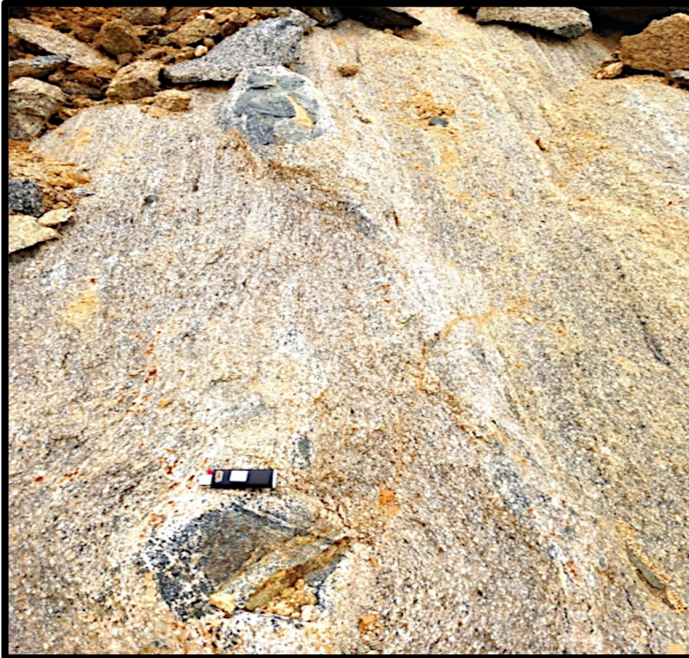
Figura 58 - Foto da composição das rochas gnáissico-migmatíticas do Complexo São Francisco do Sul, com destaque para os enclaves máficos.
