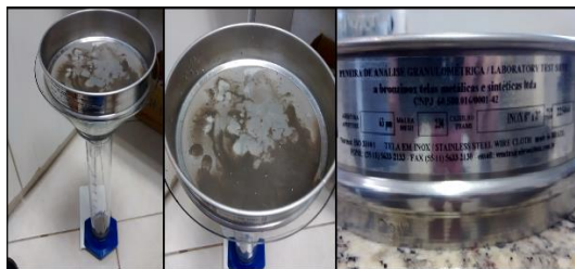
Figura 8 - Separação de grãos grossos e finos pela peneira de malha 0.0062mm.
