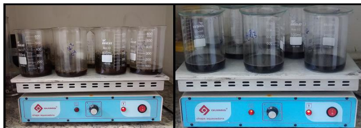
Figura 6 – Amostras com solução de ( H_2O_2 ) levadas à chapa aquecedora a 80^\circ C .
