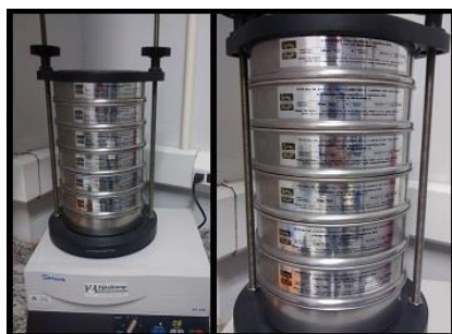
Figura 9 - Agitador mecânico e peneiras de separação de grãos.
