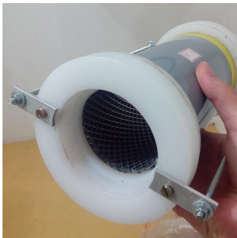
Figura 5.9. Foto de um atenuador testado para duto de DN 3" e 12,7 mm de espessura de revestimento.
