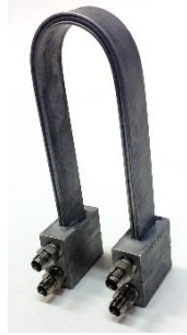
Figura 3.6 – Trocaador de calor interno de alumínio e de microcanais
