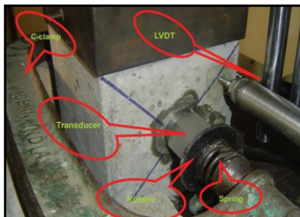
Figura 2.14: Instalação experimental para medição com ultrassom.
