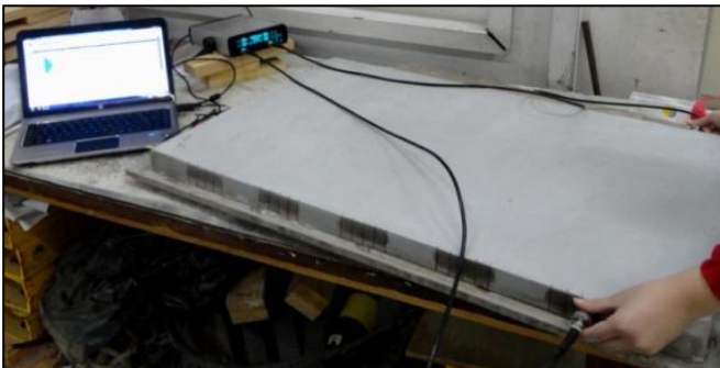
Figura 3.4: Ensaio de ultrassom com PUNDIT Lab® em uso.
