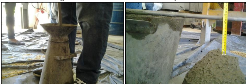
Figura 4.4: Ensaio de abatimento Slump Test.
