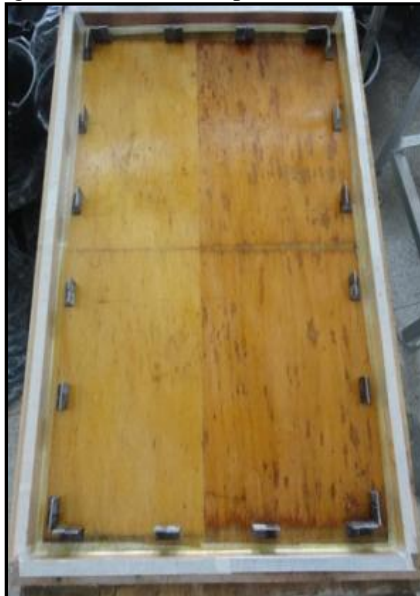
Figura 3.1: Fôrma das placas de concreto.
