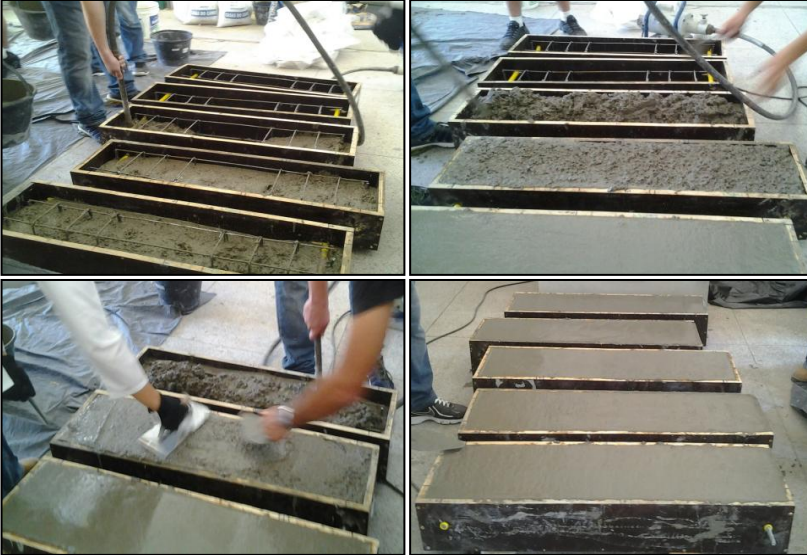
Figura 4.2: Moldagem, adensamento e nivelamento das vigas.
