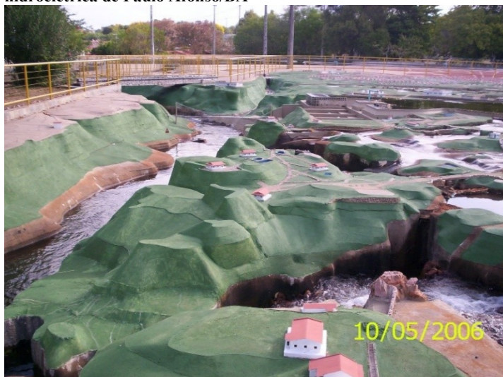
Figura 2-2. Modelo em escala reduzida da área de implantação da usina hidroelétrica de Paulo Afonso/BA
