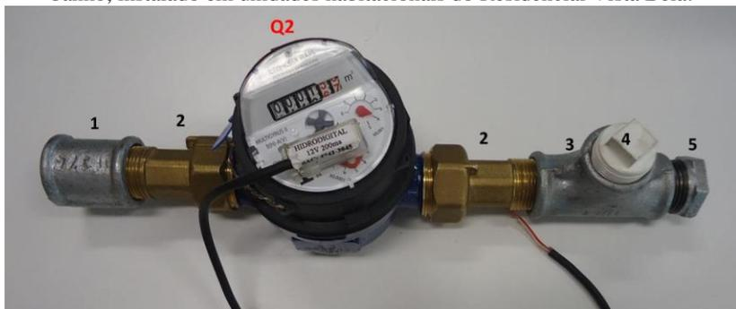
Na Figura 49 tem-se: (1) peça em ferro galvanizado para conexão do misturador externo ao conjunto formado pelo hidrômetro; (2) peças de conexão do hidrômetro em cobre; (3) conexão TE em ferro galvanizado para receber o sensor de temperatura T2; (4) peça plástica de fechamento superior da conexão TE, a qual deve ser perfurada para a passagem do sensor T2; (5) peça de conexão do TE com o chuveiro elétrico. O conjunto permitiu a medição do tempo e temperatura de banho.
