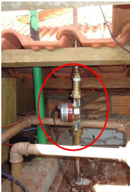
O hidrômetro Q2, durante os testes, era o único equipamento nacional do conjunto. Foi adotado por apresentar melhor resolução<sup>18</sup> na medição de eventos de banho. A incerteza de resolução é de  $\pm 1$  litro. Devido aos problemas encontrados com o hidrômetro importado, os testes foram conduzidos com hidrômetros nacionais.
