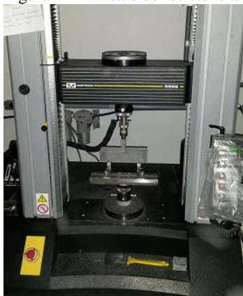
Figura 12 – Ensaio de resistência à flexão.
