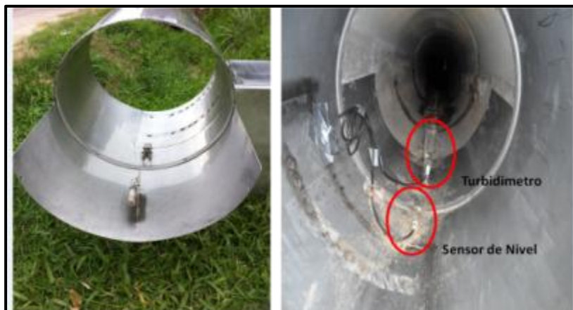
Figura 16- Instalação do sensor de nível e do turbidímetro
