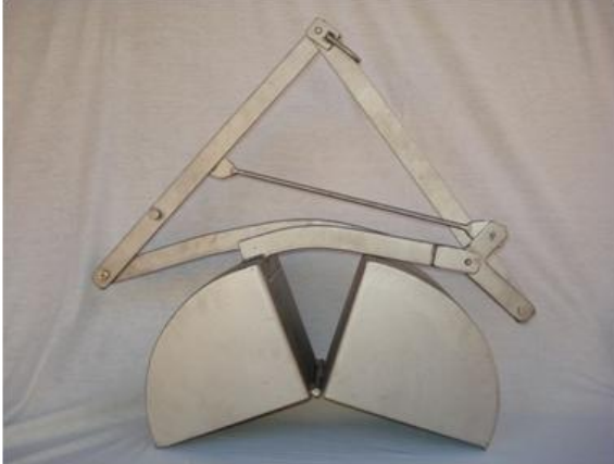
Figura 8. Amostrador do tipo van Veen, utilizado para a coleta das amostras
